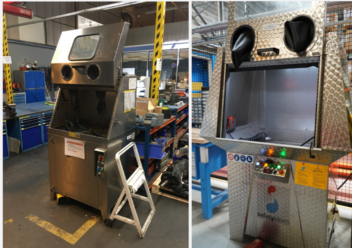
Exemple de fontaines de dégraissage en maintenance
