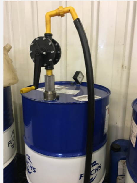
Exemple de pompe manuelle sur fût
